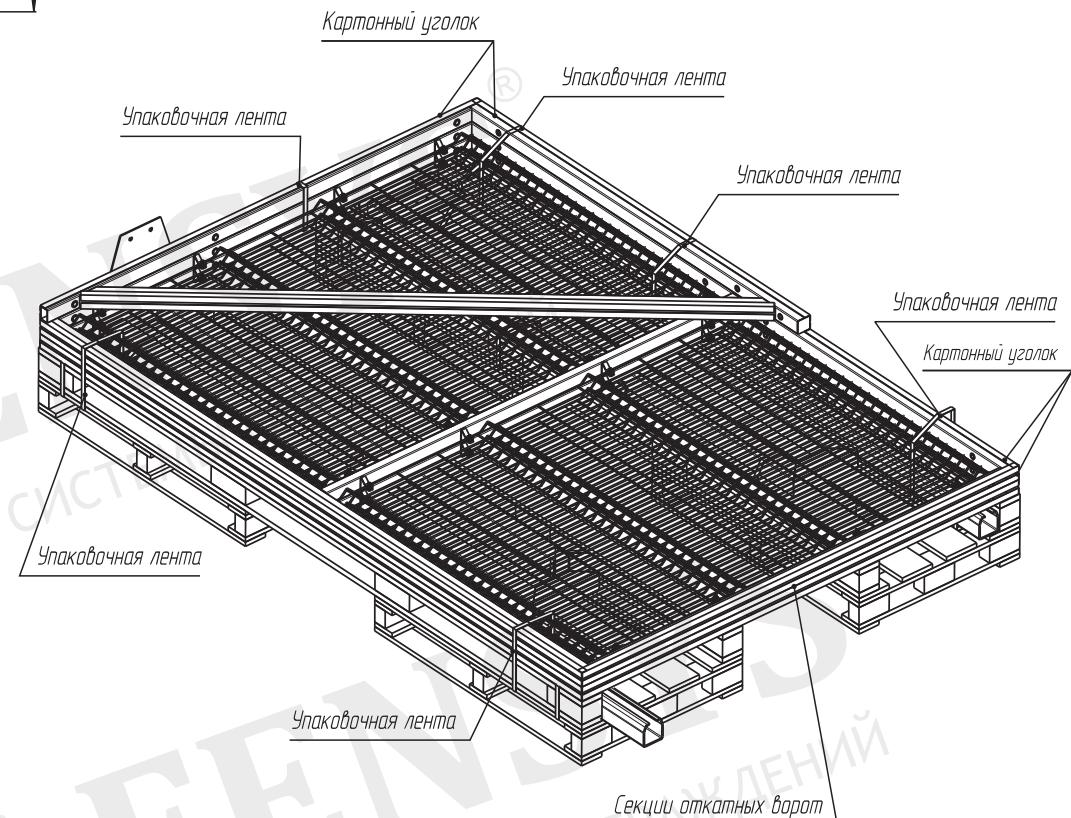
По периметру каждой секции уложить защитный картонный уголок 25х25х2мм
